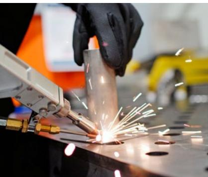
**Bei Handgeräten zum Laserschweißen** kommt oft die Sicherheit zu kurz.
